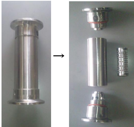
従来型ノズルフィルター 組立時 分解時
